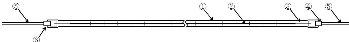
ハロゲンランプヒータ QIRシリーズとはハロゲンランプをヒーターとして応用した製品であり、一般的な照明用ハロゲンランプと基本構造、材質とも同じである。
